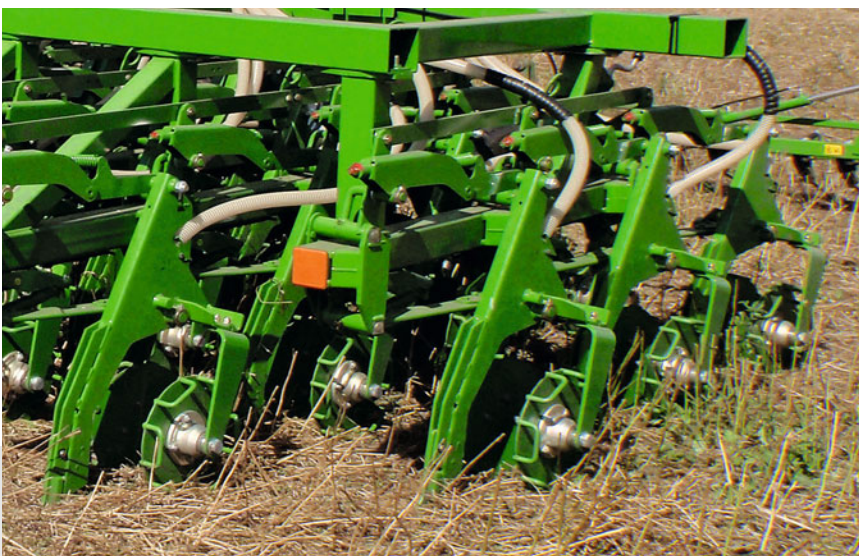
Doubles roues « reflex » pour le semis mulch et le semis direct
