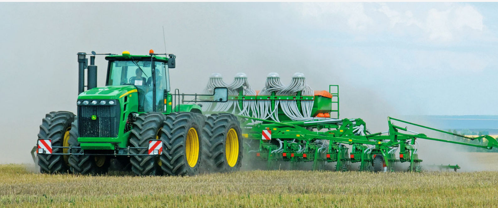
Primera DMC 12000-2C, largeur de travail 12 m
