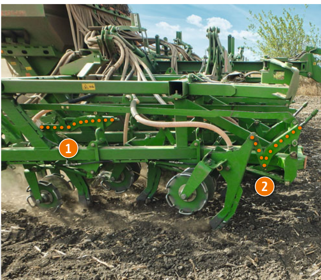
Sécurité de surcharge REVOMAT : Tirant supérieur normal ① soc à coutre en position de travail Tirant supérieur articulé ② coutre semeur « déclenché » après avoir heurté un obstacle dans le sol
