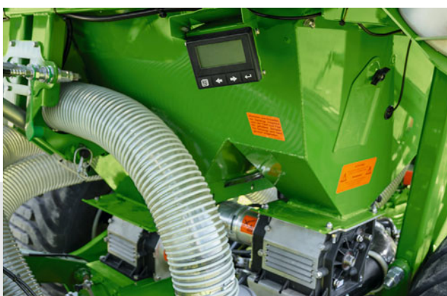
Primera DMC avec entraînement électrique de distribution et TwinTerminal
