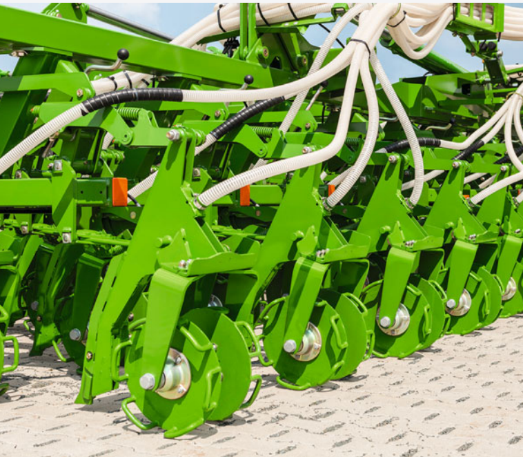
Fixation par parallélogramme des coutres semeurs
