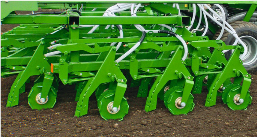
La disposition des unités de soles sur les traverses longitudinales sur 4 rangées successifs permet une distance importante entre elles. Le passage de la paille est ainsi assuré.
